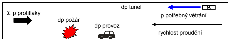
Obr. 6 Model podélného větrání se směrodatnými tlaky
